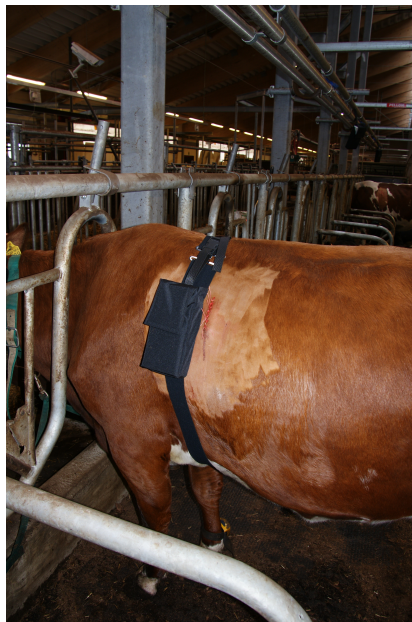
Kuva 2: Implanttidatan vastaanotin kiinnitettiin lehmän kylkeen loimivyön avulla (kuva Lilli Frondelius).
